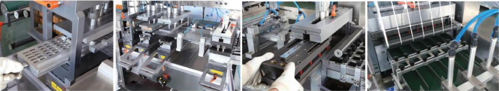
▲ 无工具更换模具 Change mould without tool ▲ 开放式更换模具 Open frame of mould changing ▲ 无工具更换冲模 Change punch mould without tool ▲ 冲裁药板输出装置 Blister output device
