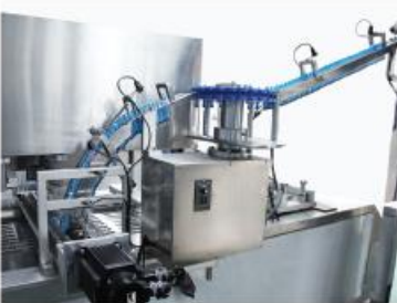
▲ 无针头剔除装置 No needle rejection device
