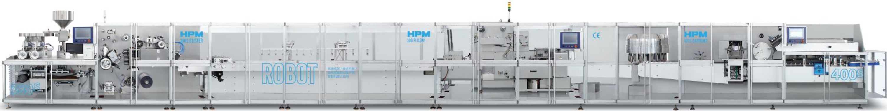
▲ 高速泡罩包装机 High speed blister packing machine
