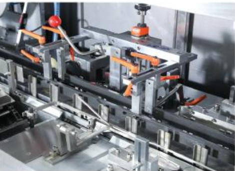
▲ 打开式压纸盒装置 Box pressing device can be easy open
