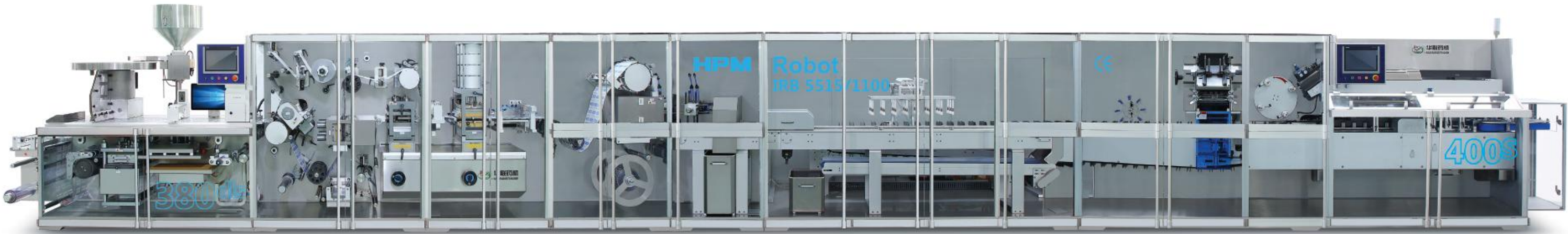
▲ 高速铝塑铝泡罩包装机 High-speed ALU-PVC-ALU blister packing machine
