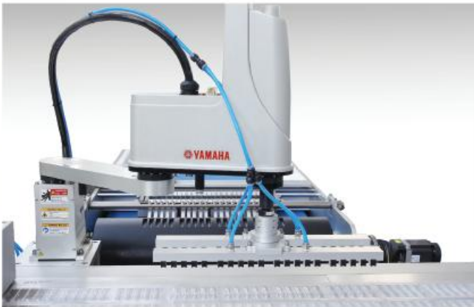
▲ 同步进料装置 Synchronous feeding device
